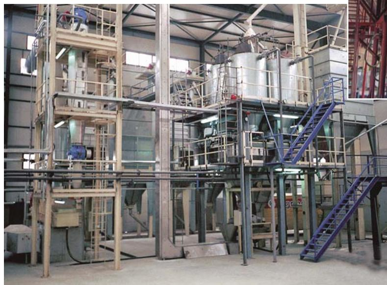
Гидротермическая установка непрерывного действия
