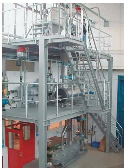
Пилотная гидротермическая варочная установка
